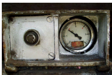
slika 8b - otvorena kutija s manometrom R-kočnice
