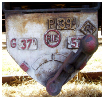
slika 12a - ručica mjenjača G - P(RIC) - R na putničkom vagonu
