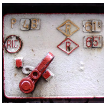
slika 12c - ručica mjenjača P(RIC) - R - R s brzačima na putničkom vagonu
