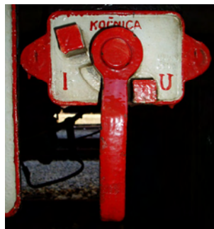
slika 4 - ručica uključno-isključne slavine (kočnica uključena)
