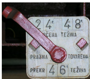
slika 15 –ručica mjenjača kočne sile na teretnom vagonu
