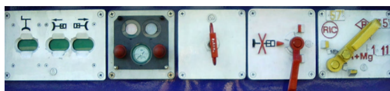
slika 12e - primjer kočničkih uređaja na bočnoj strani putničkoga vagona
