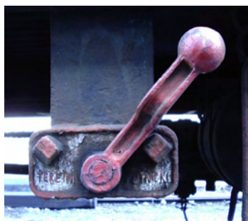
slika 13 - ručica mjenjača G - P na teretnom vagonu
