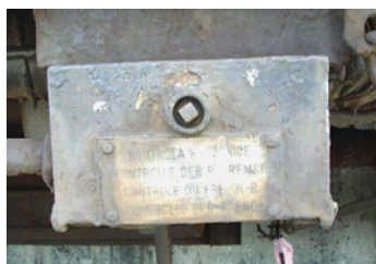
slika 8a - zatvorena kutija s manometrom R-kočnice
