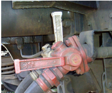
slika 2a - ručica čelne slavine glavnoga zračnog voda u položaju kada je prolazak zraka slobodan
