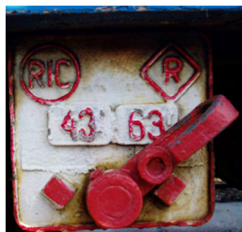
slika 12b - ručica mjenjača P(RIC) - R na putničkom vagonu
