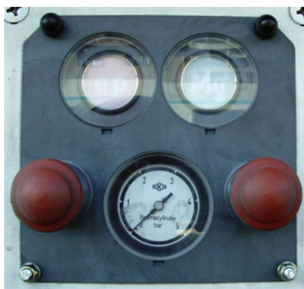
slika 11 - manometar ep kočnice i Mg kočnice
